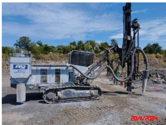
รูปที่ 24 เครื่องเจาะระเบิดที่มีอุปกรณ์เก็บฝุ่นติดไว้กับหัวเจาะ
