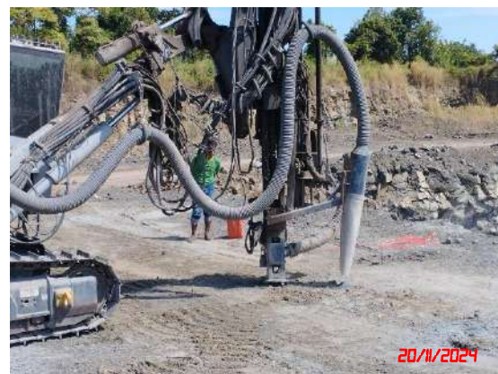
รูปที่ 24 เครื่องเจาะระเบิดที่มีอุปกรณ์เก็บฝุ่นติดไว้กับหัวเจาะ
